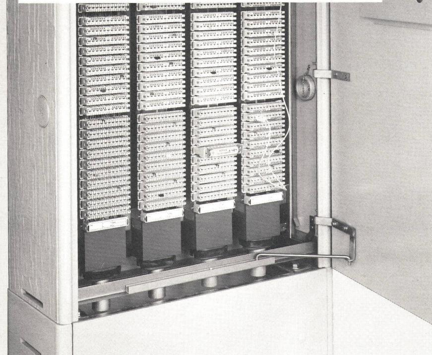
peyer Anschluss- und Verteilkästen für Kommunikations- und Signalanlagen mit PTT-kompatiblem Montagegestell sind im Vakuum-Pressverfahren hergestellt. Ihre totale Sandwich-Bauweise aus modernem Verbundwerkstoff mit Hartpolyurethan-Kern und allseitig geschlossene Kanten garantiert für:
