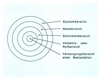
Fig. 3 Logische Bereiche eines Mobiltelefonsystems
