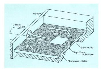
Fig. 3 Prinzip der koplanaren Flip-Chip-Montage
