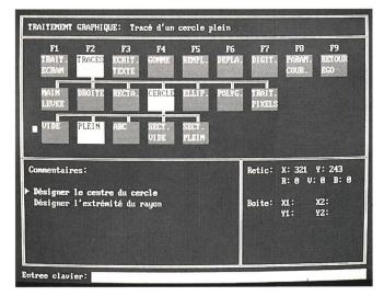
Fig. 2 L'utilisateur est guidé par un menu – lci pour la digitalisation d'un cercle plein
