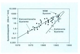
Fig. 7 Entwicklung der Glasfaser-Übertragungstechnik bezüglich der Systemkapazitäten
