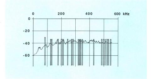
Fig. 5 Leistungsspektren der verständlichen und der unverständlichen Störungen zwischen zwei 120-Kanal-TF-FM-Systemen bei Belegung von je 10 % der Kanäle
