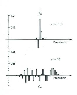
Fig. 1 FM-Spektren für kleinen und grossen Modulationsindex m
