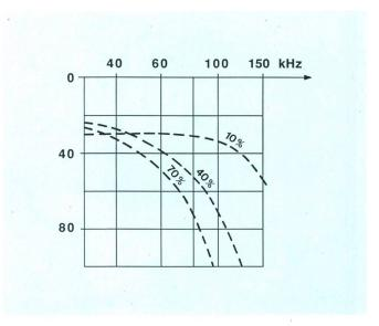
Fig. 6b Unverständliche Störungen zwischen zwei 120 Kanal TF-FM-Systemen
