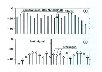
Fig. 2b Störung eines FM-Signals mit m = 8 durch einen diskreten Störer Horizontal: Frequenz in linearem Massstab Vertikal: Amplituden in Dezibel
