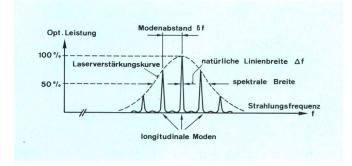
Fig. 2 Strahlungsspektrum einer Multimode-Laserdiode
