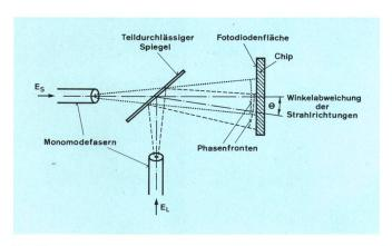
Fig. 16 Überlagerung von ungenau justierten Strahlen im Detektor
