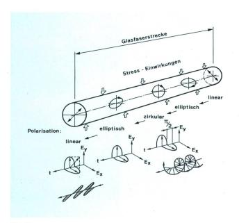
Fig. 11 Polarisationsänderungen in Standard-Monomodefasern als Folge von Stresseinwirkung
