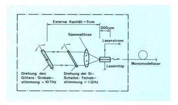
Prinzipaufbau eines Halbleiterlasers mit externer Kavität (External-Cavity-Laser; ECL)
