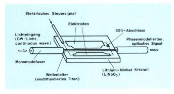
Fig. 5 Phasenmodulator
