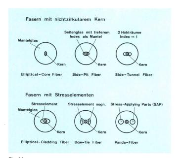
Fig. 14 Verschiedene polarisationserhaltende Fasern
