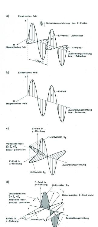
Fig. 6: Lichtwellen und Polarisation
