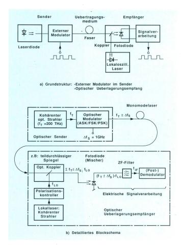
Fig. 5 Prinzip der kohärenten optischen Übertragung
