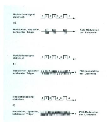
Fig. 8 Digitale Modulationsarten angewendet bei der kohärenten optischen Übertragung
