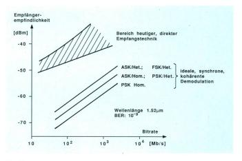
Fig. 11 Theoretische Empfindlichkeiten kohärenter optischer Empfänger
