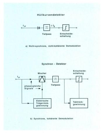
Fig. 10 Zwei übliche Demodulationsarten der Zwischenfrequenz
