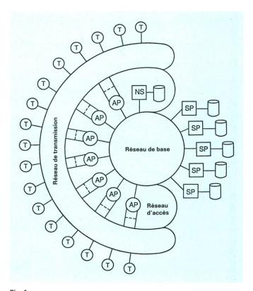
Fig. 1 Le réseau d'accès en tant qu'élément de l'infrastructure de réseau pour les applications télématiques – La rete di accesso quale parte dell'infrastruttura di rete per applicazioni di telematica
