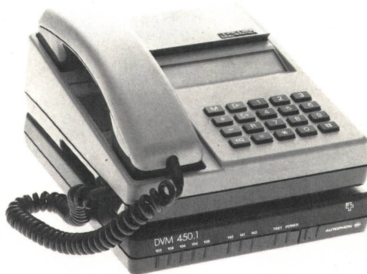
Fig. 6 Terminal d'abonné au système DOV avec appareil téléphonique — Apparecchio di utente del sistema DOV con telefono
