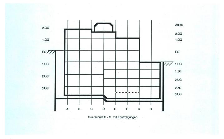
Fig. 4 Querschnitt mit Kontrollgängen
