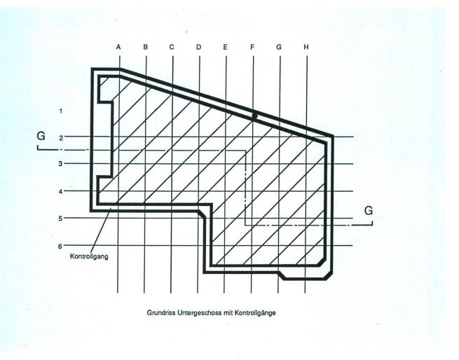
Fig. 3 Grundriss Untergeschoss mit Kontrollgängen
