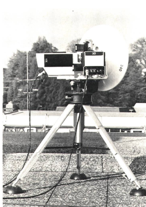
Fig. 11 Eine betriebsbereite mobile TV-Richtfunkstation mit zwei GLOBAL-IX-Sendern im (1+1)-Betrieb
