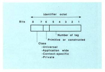
Fig. 5 Octet d'identification isolé
