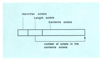
Fig. 4 Structure de codage de la syntaxe de transfert
