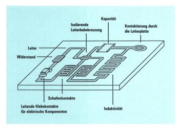
Fig. 1 Anwendungsmöglichkeiten der PTF-Technik
