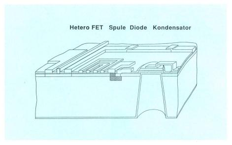
Fig. 4 Schematischer Aufbau eines M<sup>3</sup> ICs mit Hetero-FET, Diode und passiven Elementen
