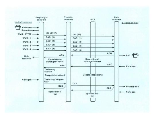
Fig. 16 Verbindungsauf- und Verbindungsabbau mit TUP (analoge Teilnehmeranschlüsse)
