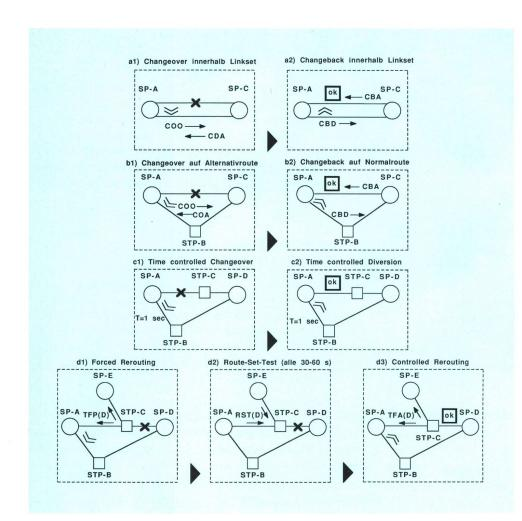
Fig. 14 Prinzip der Umschaltung, Rückschaltung und der Wahl neuer Leitwege Changeover Order COA Changeover Acknowledgment CBD Changeback Declaration Changeback Acknowledgment Transfer Prohibited TFA Transfer Allowed RST Route Set Test Nur SP-Funktion von Bedeutung 0 Nur STP-Funktion von Bedeutung Verkehrsumschaltung
