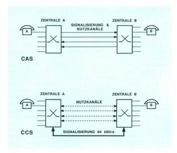
Fig. 1 Unterschied zwischen kanalassoziierter Signalisierung (CAS) und Signalisierung über gemeinsamen Signalisierkanal (CCS)
