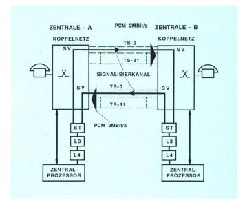
Fig. 5 Signalisierlinkbündel und Signalisierterminal
