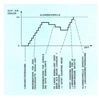
Fig. 11 Linkqualitätsüberwachung
