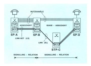
Fig. 3 Netzwerkaufbau und Komponenten
