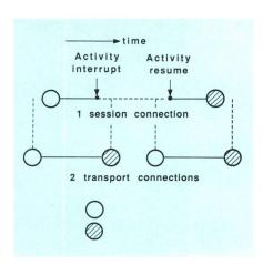
Fig. 8 Sich folgende Kommunikationssteuerungs-Verbindungen über eine Transportverbindung Time - Zeit Activity interrupt -Aktivitätsunterbruch Activity resume -Aktivitätszusammenfassung Session connections Kommunikationssteuerungsverbindungen Transport connection - Transportverbindung
