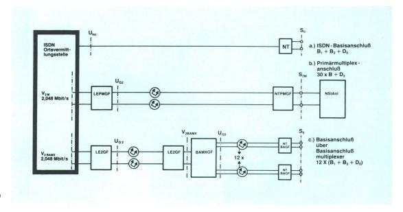
Fig. 1 ISDN-Anschlussschema mit Glasfasern
