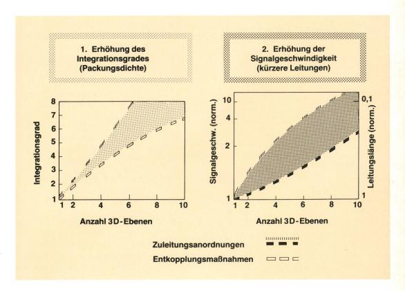
Fig. 3 Vorteile der 3-D-Integration (Abschätzung für hochkomplexen Schaltkreis)
