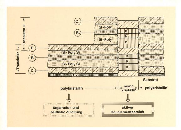
Fig. 7 Konzept gestapelter (3-D-)Transistoren, integrierbar mit der Technik der «differentriellen MBE» (Separation durch Polysilizium)
