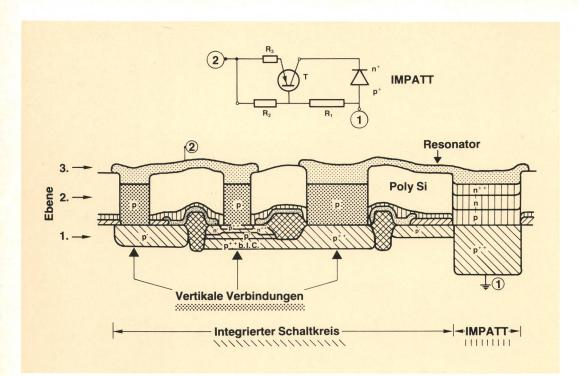
Fig. 11 3-D-SIMMWIC (Silizium-Millimeterwellen-IC): Realisierungsvorschlag mit der Technik der «differentiellen MBE»
