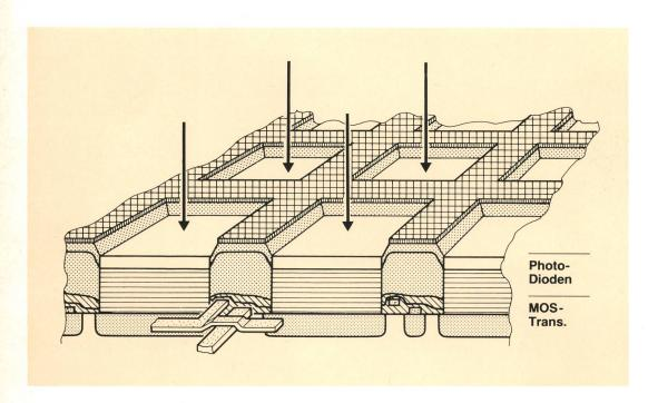
Fig. 12 Dreidimensional angeordnetes Bildsensor-Array mit Auslesetransistoren
