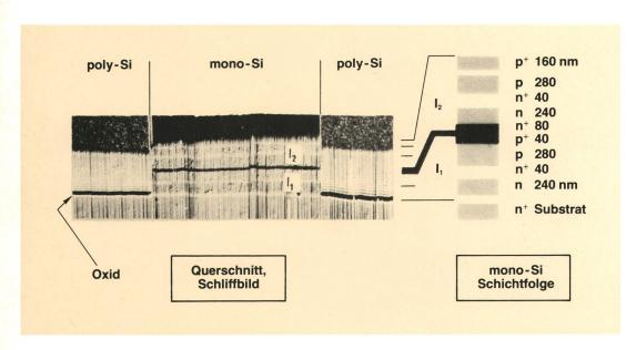
Fig. 8 Realisiertes 3-D-Bauelement aus zwei gestapelten IMPATT
