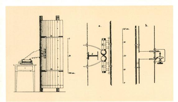
Fig. 4 Heinrich Hertz' Hohlspiegelantenne zur Bündelung elektromagnetischer Wellen [12]
