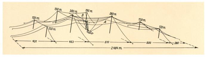
Fig. 10 Antennenanlage der Station Nauen, 1916...1919 [25]
