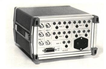
Fig. 6 Stereosignaldurchschaltegerät mit IEC-Bus
