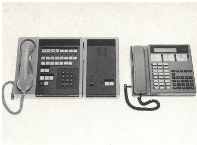
Fig. 3 Confronto fra la grandezza di un LWA 8/15 con altoparlante supplementare e di un LW 700 Commercio: i due apparecchi offrono le stesse prestazioni
