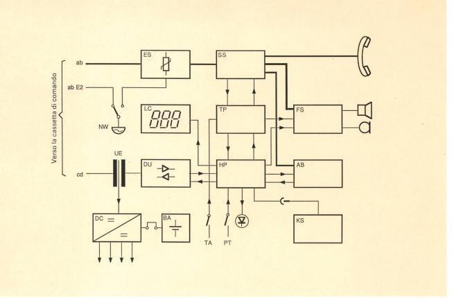
Fig. 7 Schema a blocchi del LW 700 Comfort AB Risponditore automatico
