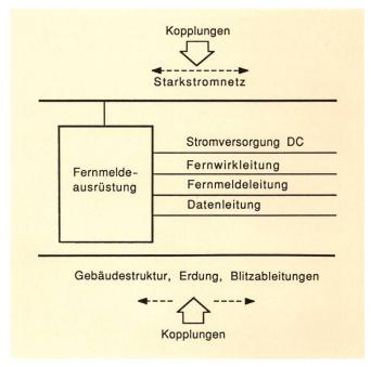
Fig. 9 Beeinflussung von Fernmeldeausrüstungen und -leitungen in Hausinstallationen
