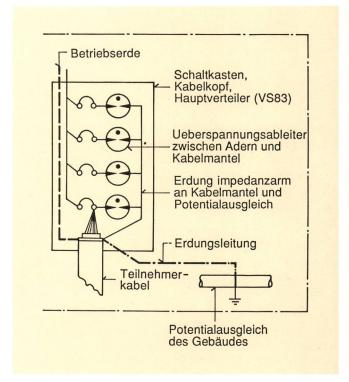
Fig. 5 Prinzip des Grobschutzes und dessen Erdung
