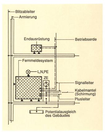
Fig. 10 Prinzip der Hybriderdung
