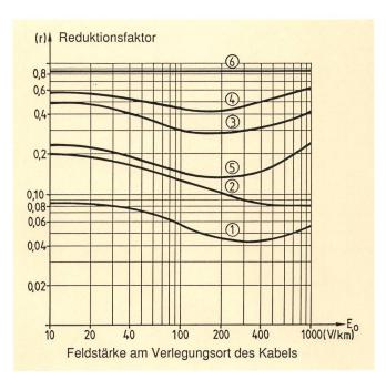
Fig. 7 Vergleich von Reduktionsfaktoren verschiedener Fernmeldekabel und Verlegungsarten bei 50- und 16²/₃-Hz-Beeinflussung
