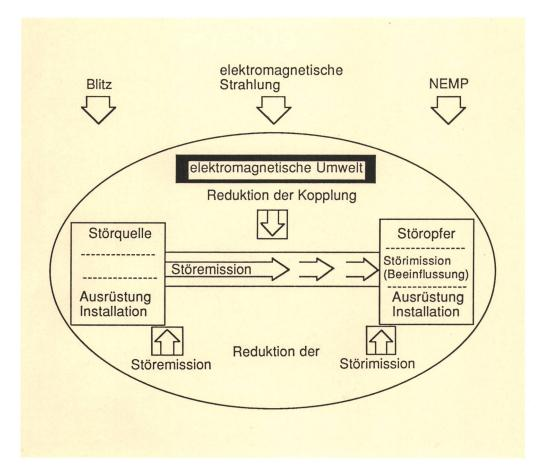
Fig. 1 Elektromagnetische Verträglichkeit. Beziehung zwischen Störquelle, Störopfer, Störemission und Störimmission
