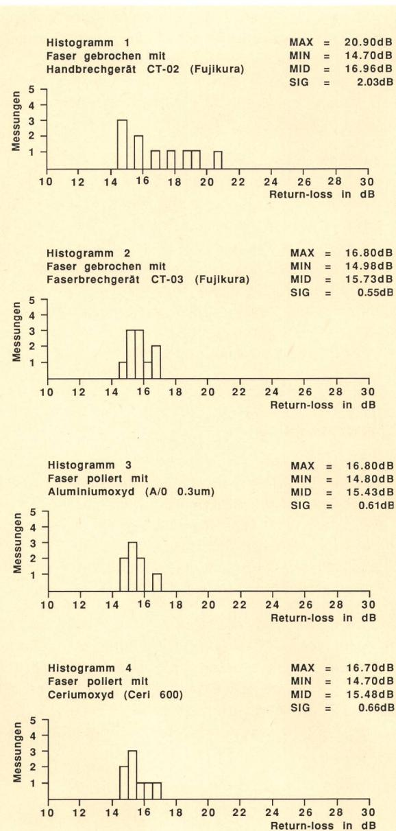
Fig. 12 Rückflussdämpfung eines Faserendes (trocken) – Taux de réflexion d'une extrémité de fibre (sèche)
