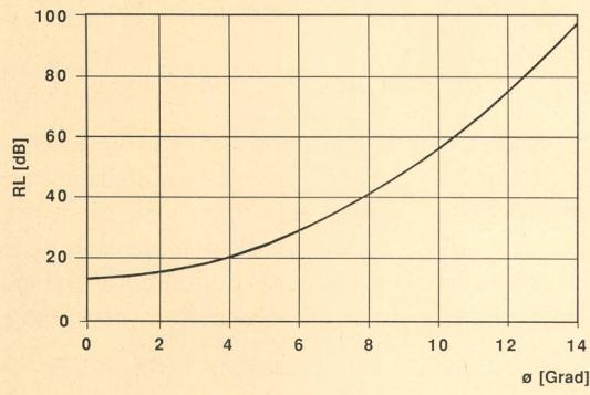
Fig. 11 Rückflussdämpfung RL eines Faserendes in Funktion des Winkels  $\Phi$  zwischen der Faserstirnfläche und Faserachse (Monomodefaser) – Taux de réflexion RL d'une extrémité de fibres en fonction de l'angle  $\Phi$  entre la face et l'axe de la fibre (fibre monomode)
