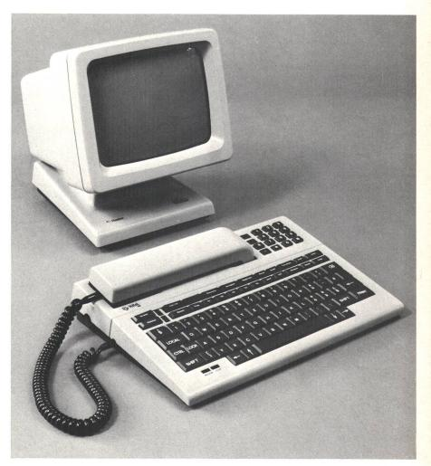
Fig. 1 Vittel 100, poste téléphonique avec possibilité de raccordement au Vidéotex
