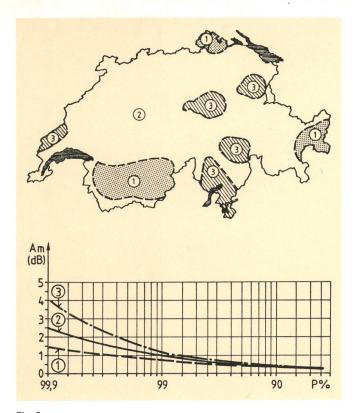
Fig. 3 Affaiblissement d'absorption Am (f = 11,5 GHz) Pour f:  $10 \le f \le 14$  GHz, Am (f) = Am + [1 + 0,2  $\cdot$  (f - 11,5)] dB  $1 \ge 3$  Zones climatiques et courbes correspondantes
