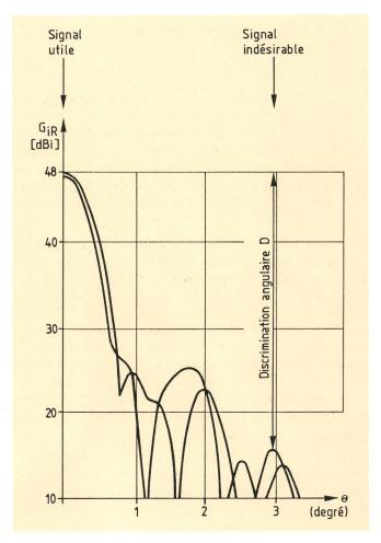
Fig. 2 Diagramme de rayonnement (D = 3 m, f = 11,2 GHz)
