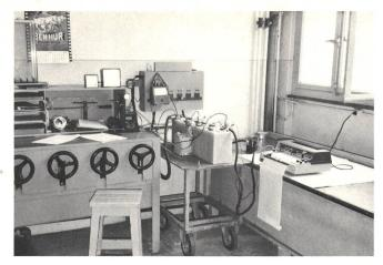
Fig. 2 Labortest zur Ermittlung der notwendigen Batteriekapazität
