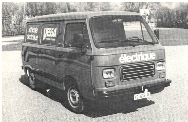
Fig. 4 Elektrifizierter Fiat-Lieferwagen VESSA/Fiat 900E Typ Transportwagen oder Kombi Geschwindigkeit 70 km/h
