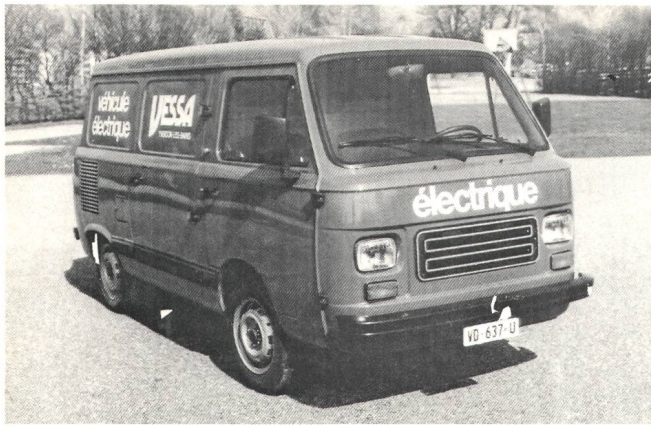
Fig. 4 Elektrifizierter Fiat-Lieferwagen VESSA/Fiat 900E Typ Transportwagen oder Kombi Geschwindigkeit 70 km/h
