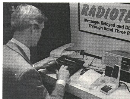
Fig. 10 Mit dem im VHF-Bereich arbeitenden «Band-III-Radiotext» wird in Grossbritannien ein verhältnismässig einfaches und kostengünstiges Datenübermittlungsverfahren für mobile Anwendungen landesweit verwirklicht. Unser Bild zeigt das Terminal mit Thermodrucker (links) und die Verbindungseinheit zum Radiotext-Netz
