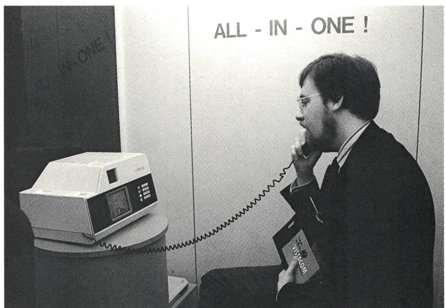
Fig. 6 Als weitere Premiere stellte die finnische Vistacom OY die zweite Generation ihres Videofons vor, das Telefonapparat, Codec und eine (enhanced) Videoausrüstung – mit 240 x 256 pixels – in einem Gerät enthält und direkt an eine 64-kbit/s-Leitung anschliessbar ist. Dieses Videofon soll ab Herbst aus Serienfertigung auf den Markt kommen
