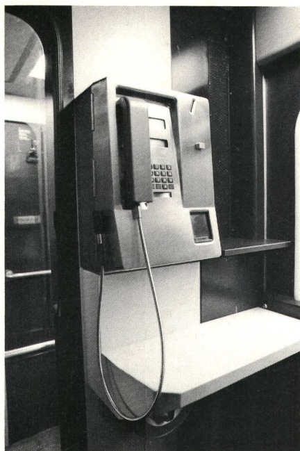
Fig. 5 Einschlitzz-Kassierstation Telca-Star – Poste à prépaiement à une fente Telca-Star
