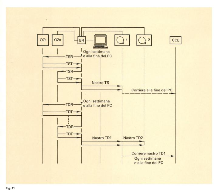
Esempio di trasmissione di dati di tassazione e di stati dei contatori di tassa
