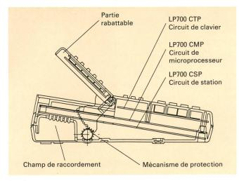
Fig. 8 Vue latérale du modèle LW 700 Confort
