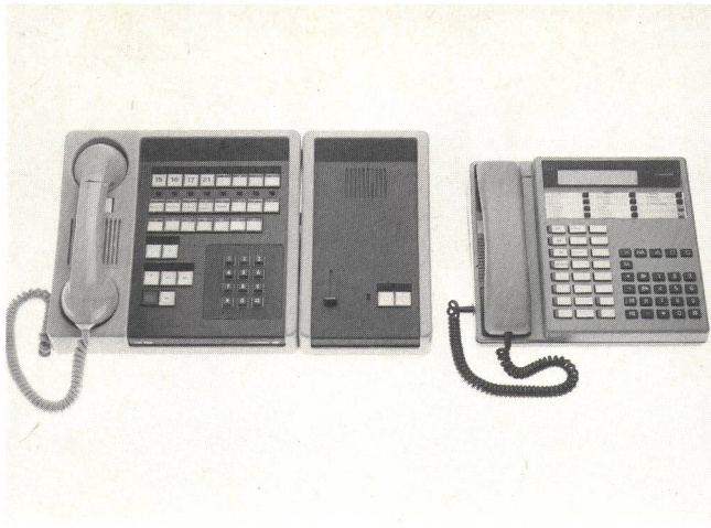
Fig. 3 Grössenvergleich zwischen einem LWA 8/15 mit Lautsprechersatz und einem LW 700 Kommerz. Beide Apparate leisten etwa dasselbe
