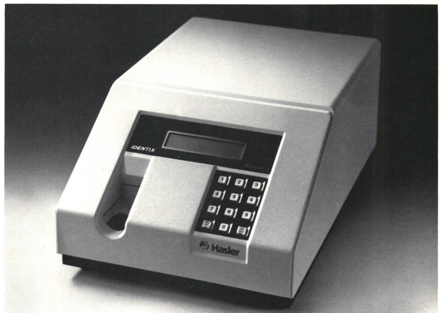
Fig. 1 Elektronischer Fingerabdruckleser für Personenidentifikation als Zutrittskontrolle für Hochsicherheitszonen – Lecteur numérique d'empreintes digitales pour l'identification des personnes et le contrôle d'accès aux zones de haute sécurité
