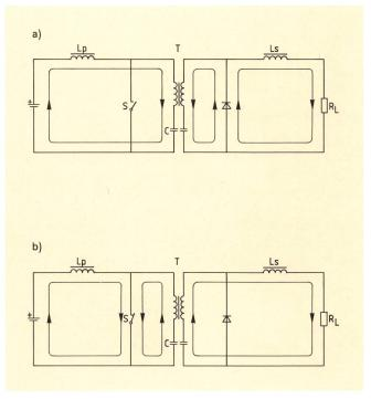
Fig. 9 Schéma de principe simplifié d'un convertisseur de Ĉuk – Schema di principio semplificato del convertitore «Ĉuk»
