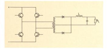
Fig. 8 Schéma de principe d'un convertisseur push-pull en pont – Schema di principio di un convertitore «push-pull» in ponte
