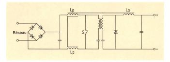
Fig. 10 Schéma de principe simplifié d'un module de redresseur de Ĉuk pour 12 A – Schema di principio semplificato di un modulo di raddrizzatore per 12 A secondo il principio di «Ĉuk»
