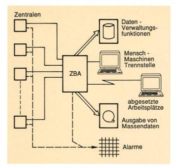
Fig. 2 Hauptfunktionen der Ausbaustufe 3 ZBA Zentralisierte Betriebsausrüstungen
