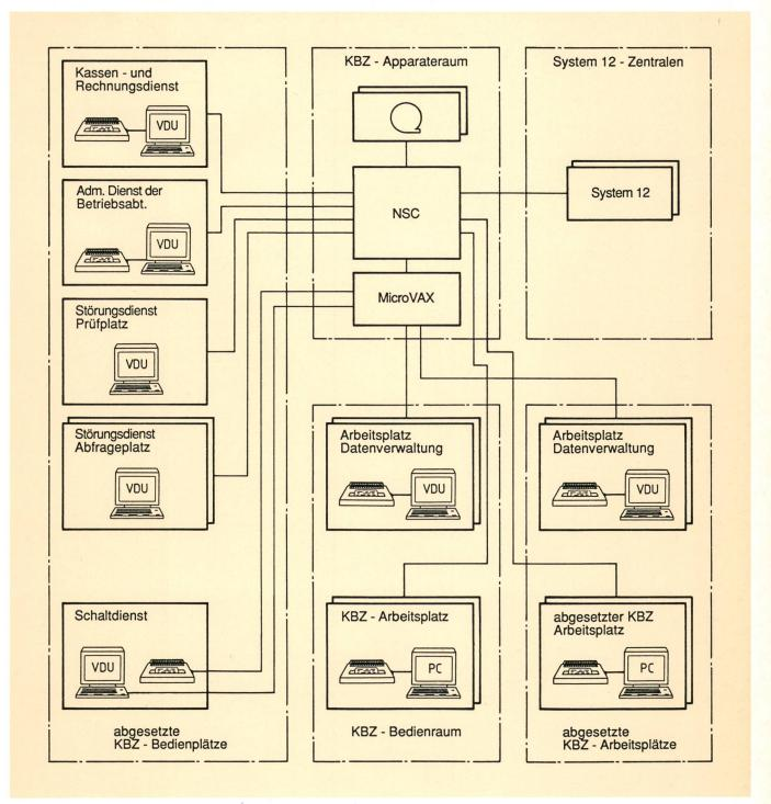
Fig. 5 Systemspezifische ZBA beim System 12 NSC Network Service Center Bildschirmterminal (visual display unit) Personal Computer mit prozeduraler Bedienung
