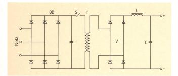
Fig. 3 Prinzip eines getakteten Gleichrichtergerätes
