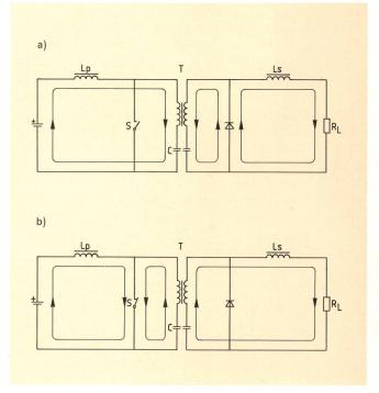
Fig. 9 Vereinfachtes Prinzipschema des Ĉuk-Wandlers a) mit offenem Halbleiterschalter
