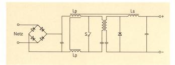
Fig. 10 Vereinfachtes Prinzipschema eines Gleichrichtermoduls 12 A nach dem Prinzip von Ĉuk
