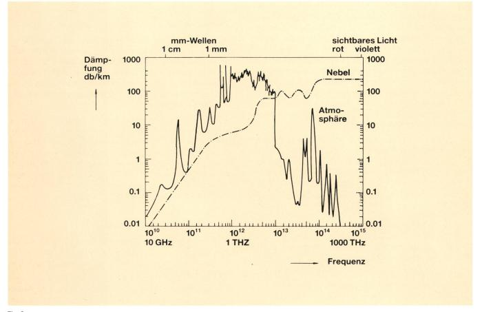
Fig. 2 Dämpfung der elektromagnetischen Wellen in der Atmosphäre und bei Nebel
