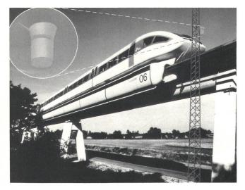
Fig. 5 mm-Wellen-Funksystem für Magnetschwebebahn
