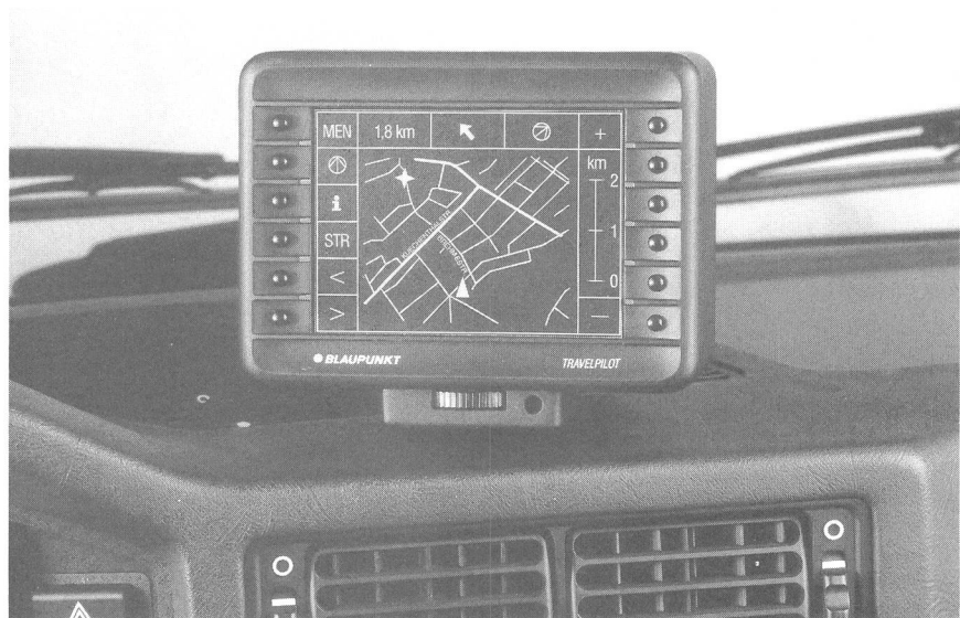
Fig. 1 Sicht- und Bedienungsgerät des Travel-Piloten. In der Mitte der Kartenausschnitt mit gegenwärtigem Standort des Fahrzeuges (▲) und dem Fahrziel (+), den Streckenabschnitten, Abzweigungen und Kreuzungen. Rechts davon die sechs Tasten für die Zieleingabe mit Buchstaben und Ziffern, oben Anzeigen über Entfernung bis zum Ziel und Abzweiganzeigen, rechts Massstab (Werkfoto)
