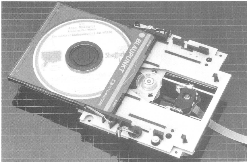
Fig. 2 Für den Einsatz im Auto entwickelter spezieller CD-Spieler für CDs in Cartridge. Dieses Gerät ist für die normale Audio- wie die «Strassen»-Disk verwendbar (Werkfoto)
