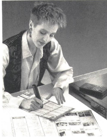
Fig. 4 Videorecorder-Programmierung mit Hilfe des Strichcodes. Da ihn die Programmzeitschriften zu den einzelnen TV-Programmen aus Platz- und drucktechnischen Gründen nicht publizieren, muss sich der Anwender für Tag, Anfangs- und Endzeit der gewünschten Sendung die erforderlichen Codes aus einer Tabelle selber zusammensetzen (Foto Blaupunkt)
