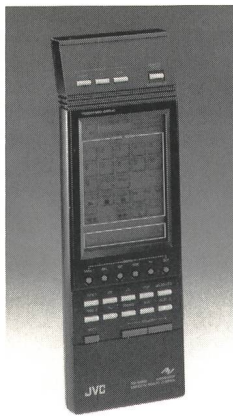
Fig. 7 Die zu jedem Gerät heute noch separate Fernbedienung wird vielleicht schon bald der Vergangenheit angehören. Erste universelle Fernbedienungen für alle erdenklichen Funktionen wurden bereits gezeigt. Unser Bild zeigt eine anspruchsvolle Lösung mit nur wenigen Tasten und aktiven LCD-Sensorfeldern (Foto Autor)
