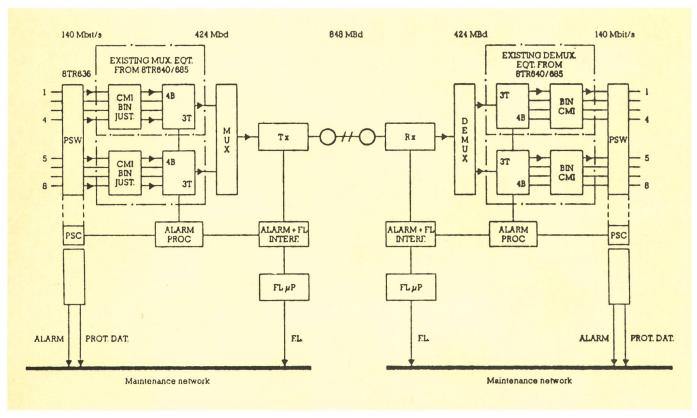
Fig. 1 Blockschema des optischen 1,13-Gbit/s-Übertragungssystems
