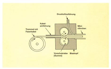
Fig. 1 Blaskopf und Wirkungsweise des Einblassystems für Glasfaserkabel
