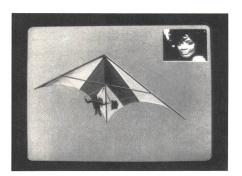
Fig. 2 «Bild im Bild» ist eine der Möglichkeiten, die der Bildspeicher zu realisieren erlaubt
