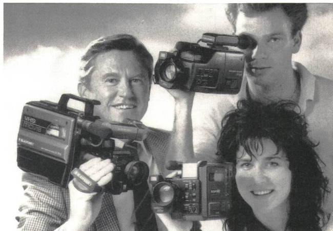
Fig. 6 Die drei heute auf dem Markt befindlichen Camcordersysteme auf einem Bild zeigen die Ähnlichkeiten in Grösse und Ausstattung. V.l.n.r.: Kamera mit der normalgrossen, mit der kleinen VHS-C-Kassette (die in jedem VHS-Gerät mit einem Adapter abspielbar ist) und mit 8-mm-Kassette (Foto Blaupunkt)
