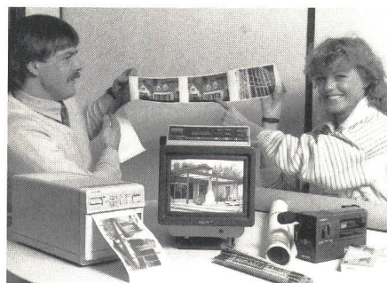
Fig. 17 «Eingefrorene» Fernsehbilder lassen sich mit diesem Videoprinter schwarz auf weiss festhalten (Foto Sony)
