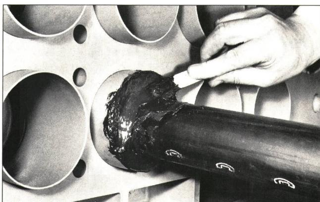
Scotchcast 9580 ist ein spachtelbares, elastisches Polyurethan-Harz: für garantiert gas- und wasserdichte Abdichtungen von Kabelkanälen, Kabel-, Gas- und Wasserrohreinführungen in Gebäude; auch für Dichtungen zwischen Rohr und Mauerwerk.
