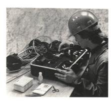
Das von ANT entwickelte Lichtwellenleiter-Spleißgerät OIS-M I für unlösbare Verbindungen von Glasfasern ("Sandwich-Technik")
