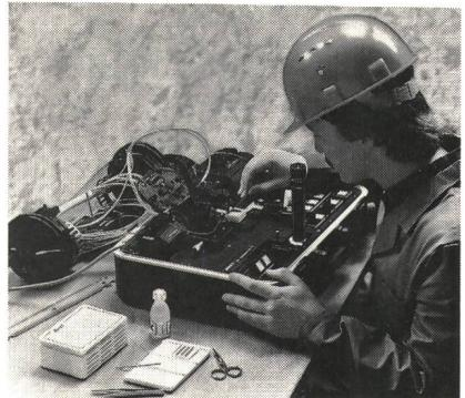
*Das von ANT entwickelte Lichtwellenleiter-Spleißgerät OIS-M 1 für unlösbare Verbindungen von Glasfasern („Sandwich-Technik“)*
