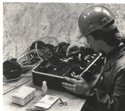
Das von ANT entwickelte Lichtwellenleiter-Spleißgerät OIS-M 1 für unlösbare Verbindungen von Glasfasern („Sandwich-Technik“)
