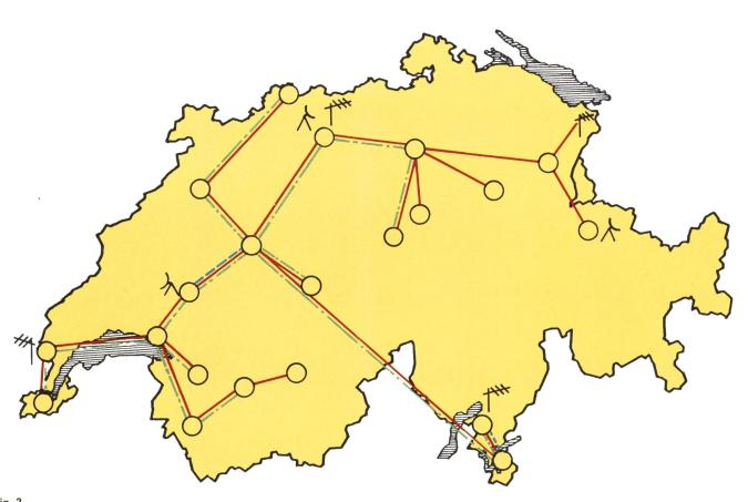
Fig. 2 Schematische Darstellung des Programmzubringer-Richtstrahlnetzes Rappresentazione schematica della rete di ponti radio per adduzione di programmi alle antenne collettive
