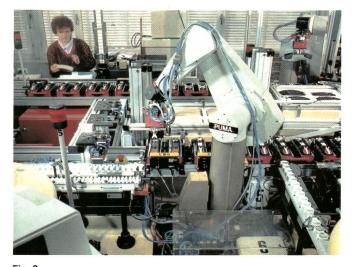
Montageroboter für Telefonkapseln bei Zellweger Robot di montaggio per capsule telefoniche della ditta Zellweger
