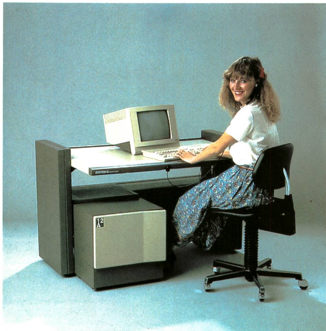
Fig. 4 Vermittlungsarbeitsplatz mit DOP Posto di lavoro commutazione con DOP
