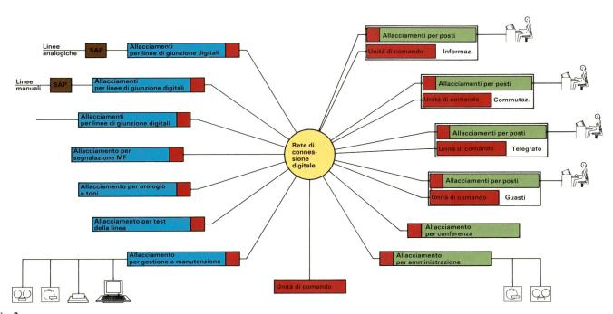
Fig. 3 Struttura della centrale per servizi manuali
