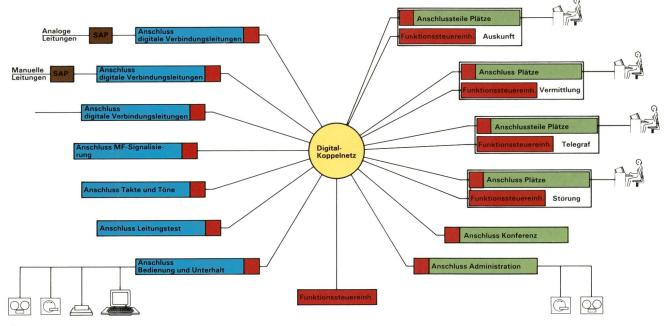
Fig. 3 Struktur der Zentrale für Manuelle Dienste
