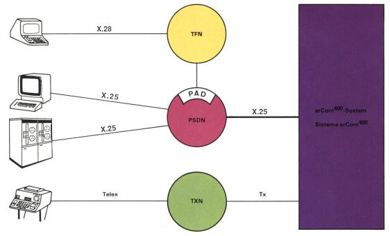
Fig. 2 Zugangsmöglichkeiten zum «arCom<sup>400</sup>»-System Possibilità di accesso al sistema «arCom<sup>400</sup>» Telefon-Wählnetz - Rete telefonica pubblica PSDN Paketvermittlungsnetz - Rete di commutazione a pacchetto
