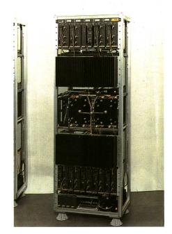
Fig. 7 HF-Ausrüstungen einer Basisstation für 8 Kanäle Equipaggiamenti AF di una stazione base per 8 canali
