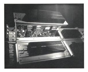
Fig. 1 Ansicht eines 1,13-Gbit/s-Multiplexers für optische Übertragungssysteme
