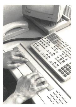
Display mit Braille-Schrift zum Kommunikationssystem Hicom
