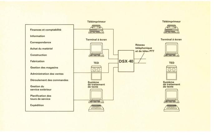
Fig. 1 Vue d'ensemble du système de commutation de messages DSX-40
