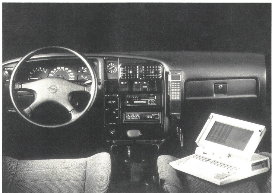
Fig. 1 Das Telefon im Auto kann mit einem Mobilmodem versehen auch zur Übertragung von Daten eingesetzt werden
