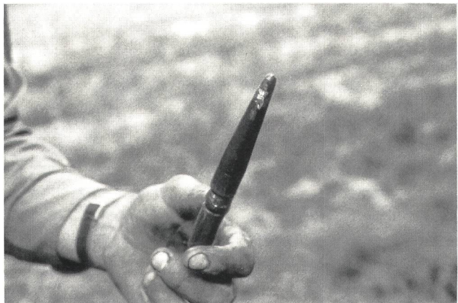
Fig. 10 Die zum Ausspülen verwendete Hochdruckdüse mit «Jet-Effekt»
