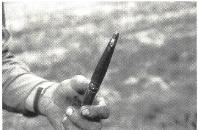
Fig. 10 Die zum Ausspülen verwendete Hochdruckdüse mit «Jet-Effekt»
