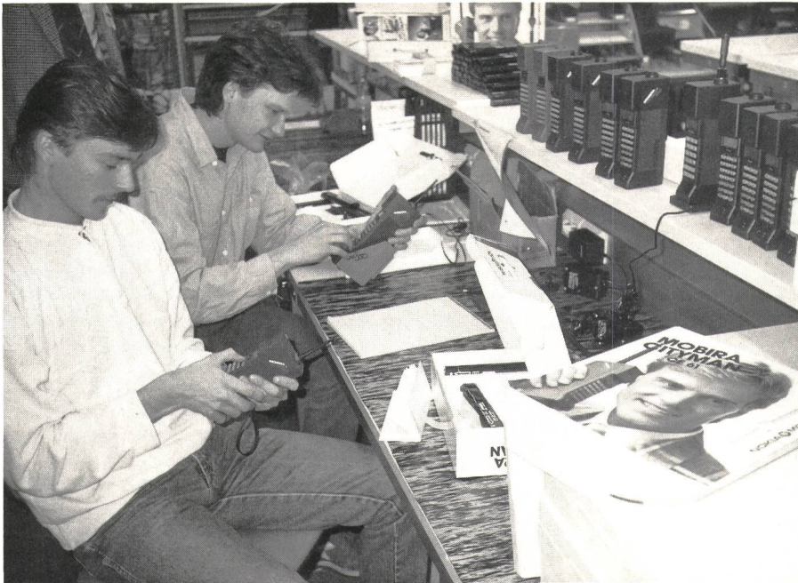
Fig. 4 Endkontrolle des Taschen-Mobiltelefons «Cityman» im Werk Salo
