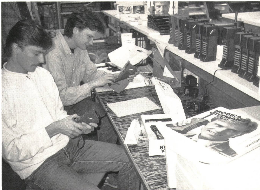
Fig. 4 Endkontrolle des Taschen-Mobiltelefons «Cityman» im Werk Salo
