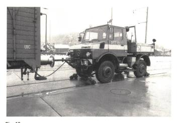
Fig. 10 Zweiwegfahrzeug Unimog
